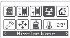
La impresora hace una lectura en el centro de la base y se detiene en el primer punto delantero izquierdo. Si el led rojo del sensor no se enciende o parpadea, significará que la distancia entre la base y el extrusor no es la correcta. Para corregirla, gira la rueda moleteada inferior correspondiente a ese punto para mover la base en el eje Z hasta que el led se encienda o deje de parpadear. El punto estará nivelado cuando la luz roja se quede fija.
