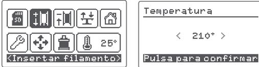
2. Una vez finalizado el proceso de calentamiento cargaremos el filamento a través del racor pasamuros, la pieza de plástico que recubre el agujero en la parte trasera de la impresora. Es muy importante colocar correctamente la bobina con el filamento saliendo desde la derecha del carrete. Corta la punta del filamento en diagonal con unas tijeras para facilitar la entrada del hilo por el tubo.
