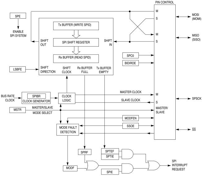
Figure 14-3. SPI Module Block Diagram
