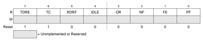
Figure 13-8. SCI Status Register 1 (SCIxS1)
