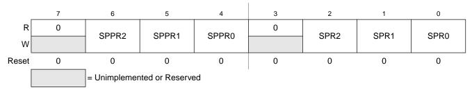
Figure 14-7. SPI Baud Rate Register (SPIBR)
