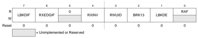
Figure 13-9. SCI Status Register 2 (SCIxS2)
