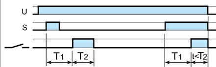
**(LE) Accionamiento intermitente asimétrico (inicio reposo) con alimentación auxiliar.**
