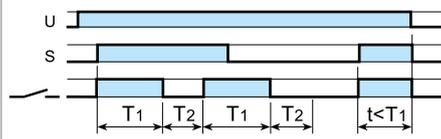
**(LE) Accionamiento intermitente asimétrico (inicio trabajo) con alimentación auxiliar.**
